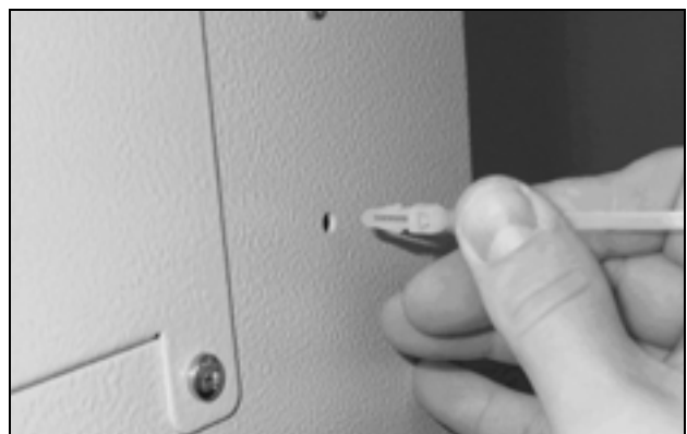
Afb. 18: Inklikkabelbinder voor trekontlasting in de voorste behuizingshelft van het klimaatmoduul vastklikken
