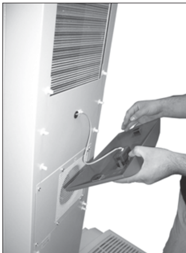
Bild 64: Ta bort mittbandet
