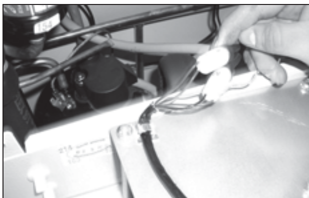
Bild 71: Dra ut fläktens kontaktdon (2)
