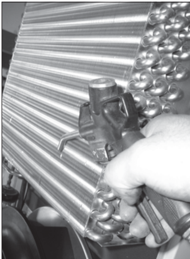
Bild 80: Rengör värmväxelpaketet och kompressorum med tryckluft (2)
