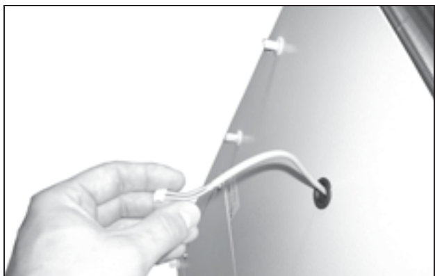
Bild 50: Skjut tillbaka displaykabeln
