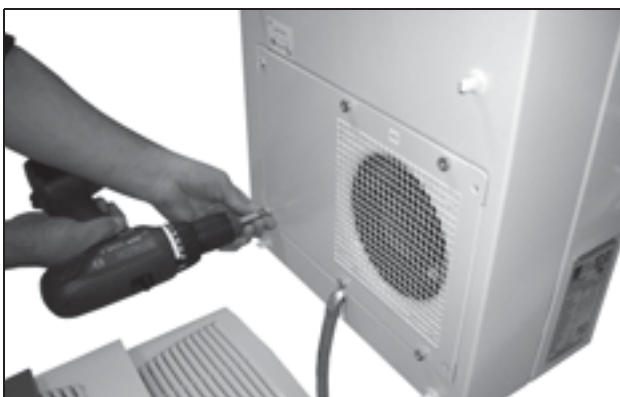
Bild 46: Demontera ytterkretsens fläkt (lossa på de fyra skruvarna)
