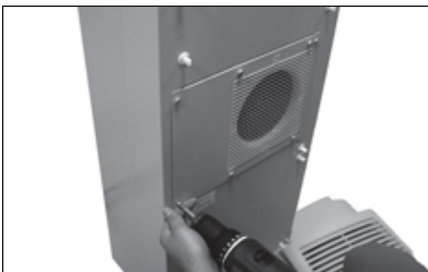
Bild 68: Loss de fyra skruvarna på ytterkretsens fläkt
