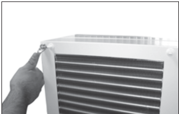
Bild 49: Demontera höljet (lossa fyra muttrar)
