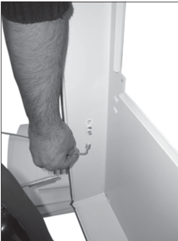
Bild 78: Dra ut jordkabeln (2)
