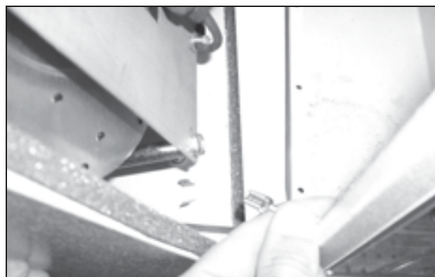
Bild 55: Lossa jordkabeln mellan höljet och chassit (2)
