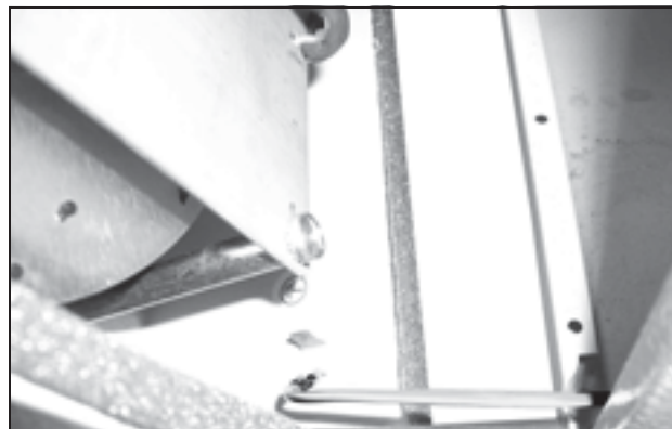
Bild 54: Lossa jordkabeln mellan höljet och chassit (1)
