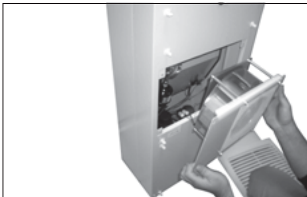
Bild 69: Demontera ytterkretsens fläkt
