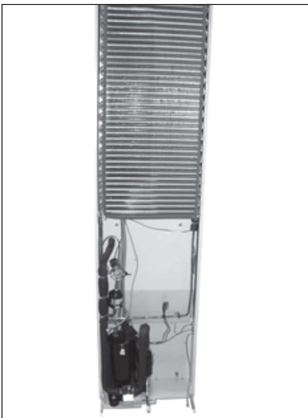
Bild 79: Rengör värmväxlare och kompressorum med tryckluft (1)
