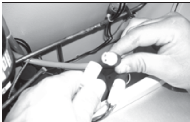
Bild 72: Dra ut fläktens kontaktdon (3)
