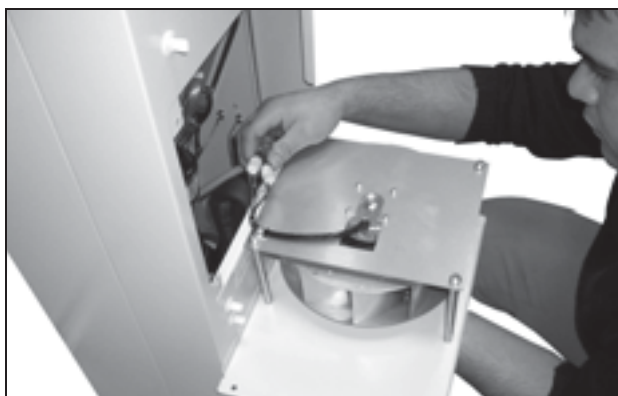
Bild 70: Dra ut fläktens kontaktdon (1)
