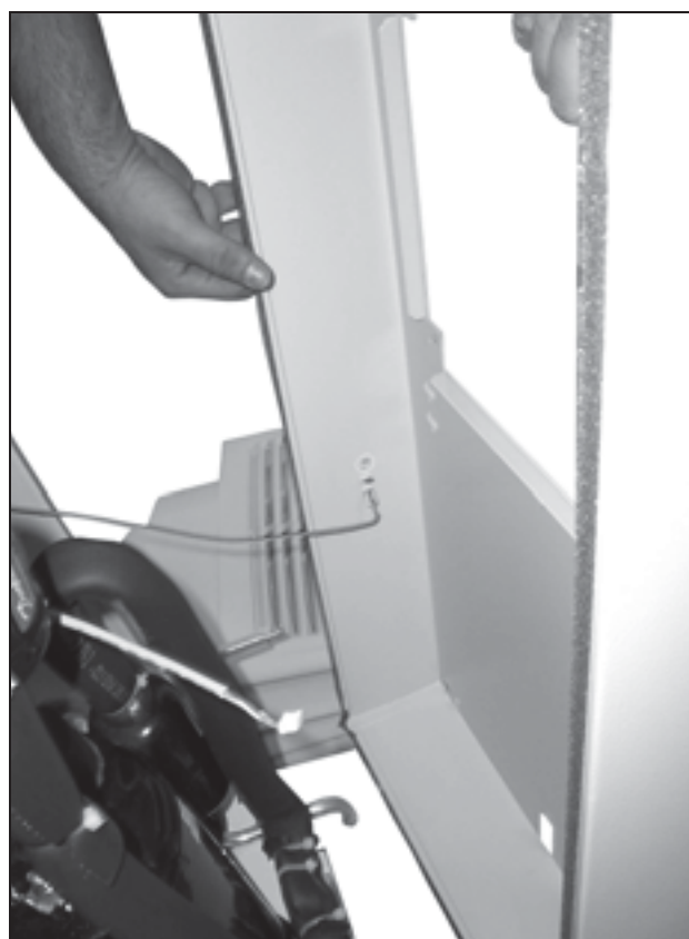
Bild 77: Dra ut jordkabeln (1)
