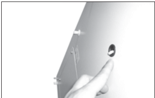
Bild 51: Tryck displaykabeln genom kabelgenomföringen
