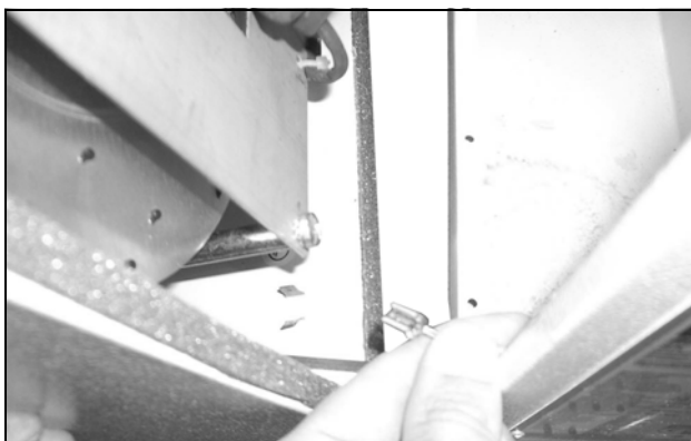
Fig. 50 : Retirer le câble de mise à la terre qui se trouve entre le capot et le châssis (2)
