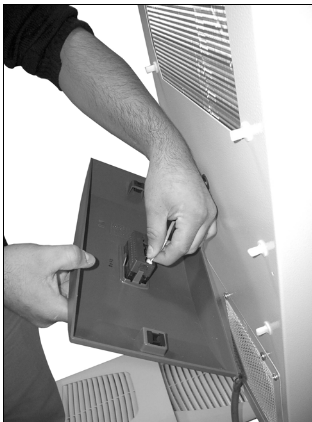
Fig. 38 : Ôter le connecteur de l'afficheur (1)
