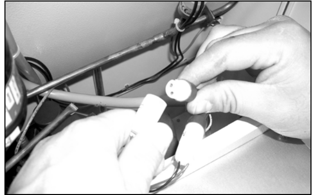
Fig. 67 : Débrancher les fiches de raccordement du ventilateur (3)
