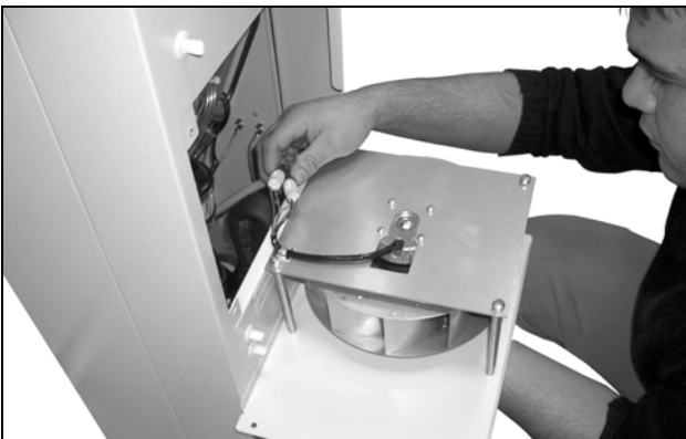
Fig. 65 : Débrancher les fiches de raccordement du ventilateur (1)
