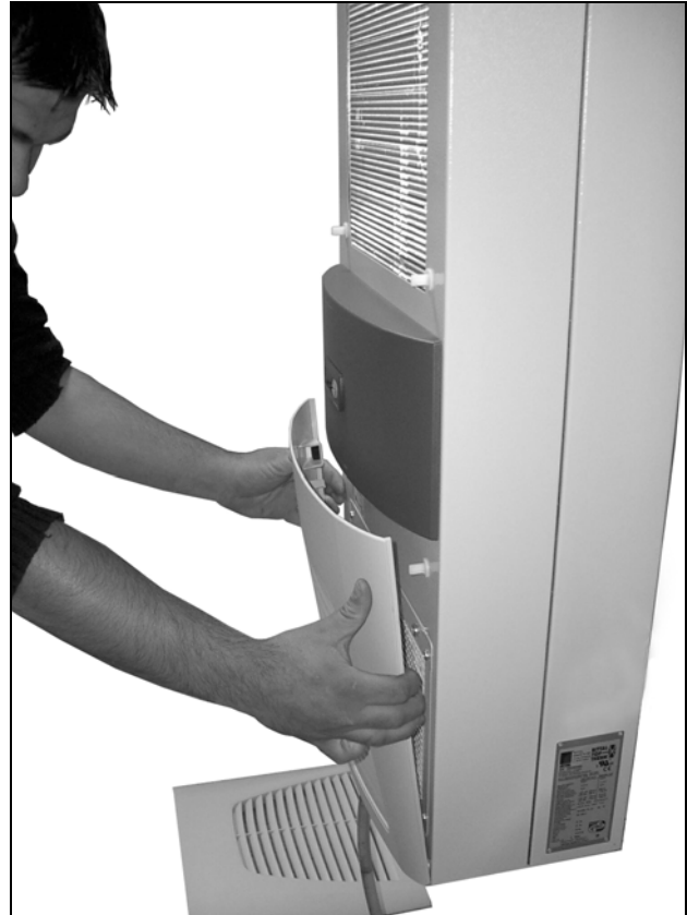
Fig. 36 : Retirer la grille à lamelles inférieure
