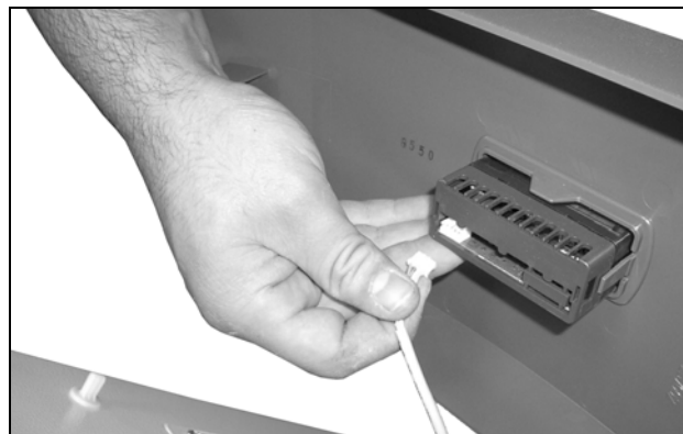
Fig. 60 : Débrancher le câble de l'afficheur
