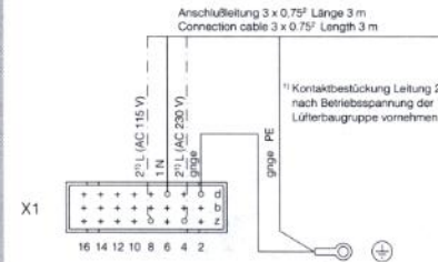
Abb. 4.6 Anschlußbelegung Führungsrahmen SK 3357 100, SK 3358 100 für Einschublüfter Vario
