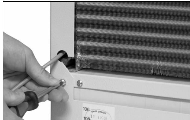
Abb. 26: Befestigungsschrauben der Haube entfernen (vier Schrauben lösen)
