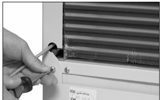
Fig. 26 : Dévisser les vis de fixation du capot (quatre vis)
