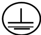
Защитное заземление является мерой, которое в случае неисправности защищает от опасного напряжения и поражения током.
