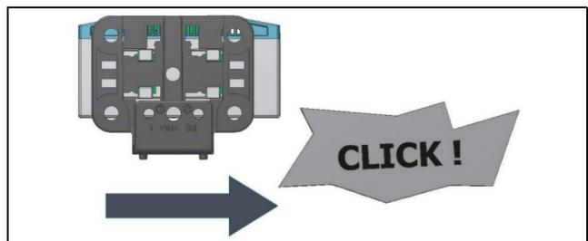
Abb. 4: Einrasten des Sensors auf dem Halter
