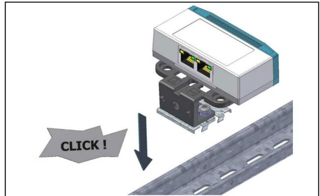
Abb. 7: Befestigen des Federclips auf der Hutschiene
