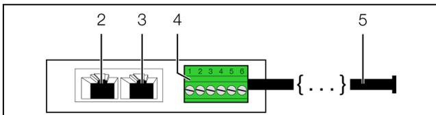
Abb. 10: Rückseite des Leckagesensors
