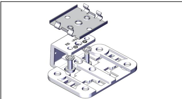
Abb. 6: Befestigen des Halters auf dem Federclip
