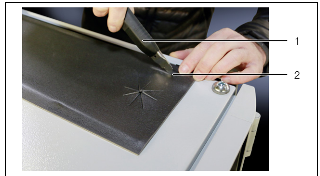
Fig. 7 : Incision pour la fixation de la brosse passe-câbles
