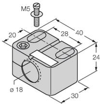
Befestigungsschelle für Gewinderohrsensoren, mit Festanschlag; Werkstoff: PA6
