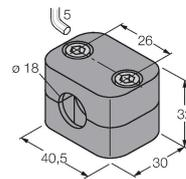
Befestigungsschelle für Glatt- und Gewinderohrsensoren; Werkstoff: Polypropylen
