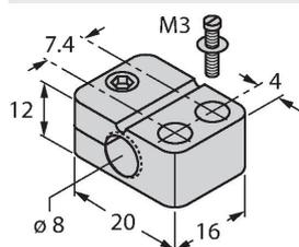
Befestigungsschelle für Gewinderohrsensoren, mit Festanschlag; Werkstoff: PA6
