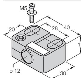
Befestigungsschelle für Gewinderohrsensoren, mit Festanschlag; Werkstoff: PA6
