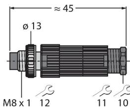
Konfektionierbarer Stecker, M8 x 1, gerade, 3-polig, Eindringtechnik, Leitungsdurchlass 4.0 bis 5.0 mm, Adernquerschnitt/ Klemmvermögen 0.14 bis 0.34 mm<sup>2</sup>, Kunststoffgehäuse, Metallüberwurfmutter
