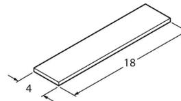
Kennzeichenschilder für TEL- und TXL-Leitungen; Schildlänge: 18 mm, Schildhöhe: 4 mm, Material: Polycarbonat (PC), Farbe: weiß, halogenfrei und flammwidrig
