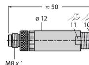
Konfektionierbarer Stecker, M8 x 1, gerade, 4-polig, Schraubklemmanschluss, Leitungsdurchlass 3.5 bis 5.0 mm, Adernquerschnitt/ Klemmvermögen 0.14 bis 0.50 mm<sup>2</sup>, Kunststoffgehäuse, Metallüberwurfschraube
