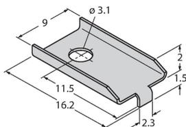
Befestigungswinkel für Quaderbauform Q4.7 oder Q5.5; Werkstoff VA 1.4401
