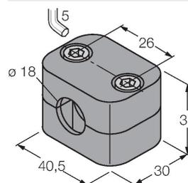
Befestigungsschelle für Glatt- und Gewinderohrsensoren; Werkstoff: Polypropylen
