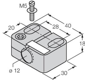
Befestigungsschelle für Gewinderohrsensoren, mit Festanschlag; Werkstoff: PA6
