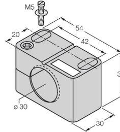
Befestigungsschelle für Gewinderohrsensoren, mit Festanschlag; Werkstoff: PA6
