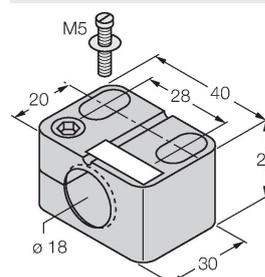
Befestigungsschelle für Gewinderohrsensoren, mit Festanschlag; Werkstoff: PA6
