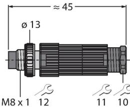
Konfektionierbarer Stecker, M8 x 1, gerade, 4-polig, Eindringtechnik, Leitungsdurchlass 4.0 bis 5.0 mm, Adernquerschnitt/ Klemmvermögen 0.14 bis 0.34 mm<sup>2</sup>, Kunststoffgehäuse, Metallüberwurfmutter
