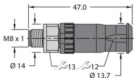
Konfektionierbarer Stecker, M8 x 1, gerade, 4-polig, Schraubklemmanschluss, Leitungsdurchlass 4.0 bis 5.5 mm, Adernquerschnitt/ Klemmvermögen 0.14 bis 0.5 mm<sup>2</sup>, Kunststoffgehäuse, Metallüberwurfschraube
