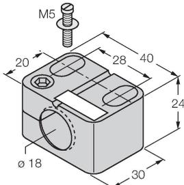
Befestigungsschelle für Gewinderohrsensoren, mit Festanschlag; Werkstoff: PA6
