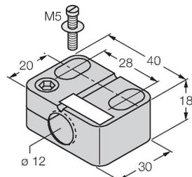
Befestigungsschelle für Gewinderohrsensoren, mit Festanschlag; Werkstoff: PA6
