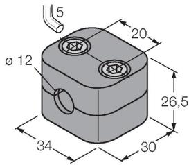
Befestigungsschelle für Glatt -und Gewinderohrsensoren; Werkstoff: Polypropylen
