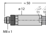
Konfektionierbarer Stecker, M8 x 1, gerade, 4-polig, Schraubklemmanschluss, Leitungsdurchlass 3.5 bis 5.0 mm, Adernquerschnitt/ Klemmvermögen 0.14 bis 0.50 mm<sup>2</sup>, Kunststoffgehäuse, Metallüberwurfschraube
