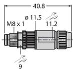
Konfektionierbarer Stecker, M8 x 1, gerade, 4-polig, Schneidklemmanschluss, Leitungsdurchlass 2.5 bis 5.1 mm, Adernquerschnitt/ Klemmvermögen 0.14 bis 0.34 mm<sup>2</sup>, Kunststoffgehäuse, Metallüberwurfmutter
