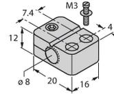
Befestigungsschelle für Gewinderohrsensoren, mit Festanschlag; Werkstoff: PA6
