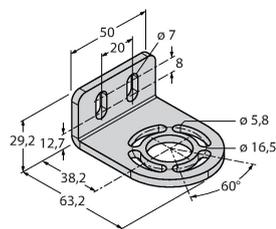
Montagewinkel, schwarz, Stahl, für EZ-ARRAY und EZ-SCREEN Standard und Kaskade 14 & 30 mm
