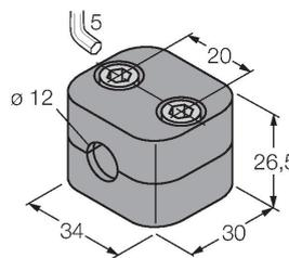
Befestigungsschelle für Glatt- und Gewinderohrsensoren; Werkstoff: Polypropylen
