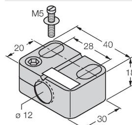
Befestigungsschelle für Gewinderohrsensoren, mit Festanschlag; Werkstoff: PA6
