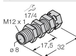
Schnellmontagehalterung mit Festanschlag; Werkstoff: Messing verchromt. Außengewinde M12 x 1. Hinweis: Der Schaltabstand der Näherungsschalter kann sich durch Verwendung von Schnellmontagehalterungen verringern.
