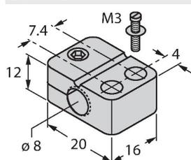
Befestigungsschelle für Gewinderohrsensoren, mit Festanschlag; Werkstoff: PA6
