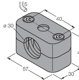
Befestigungsschelle für Glatt- und Gewinderohrsensoren; Werkstoff: Polypropylen
