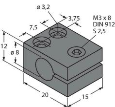
Befestigungsschelle für Gewinderohrsensoren; Werkstoff Montageblock: Aluminium, eloxiert
