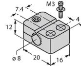
Befestigungsschelle für Gewinderohrsensoren, mit Festanschlag; Werkstoff: PA6
