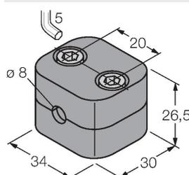
Befestigungsschelle für Glatt- und Gewinderohrsensoren; Werkstoff: Polypropylen
