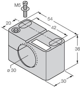
Befestigungsschelle für Gewinderohrsensoren, mit Festanschlag; Werkstoff: PA6
