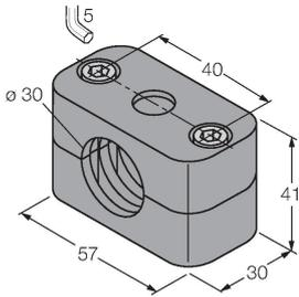
Befestigungsschelle für Glatt- und Gewinderohrsensoren; Werkstoff: Polypropylen
