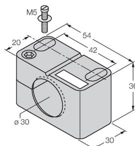
Befestigungsschelle für Gewinderohrsensoren, mit Festanschlag; Werkstoff: PA6
