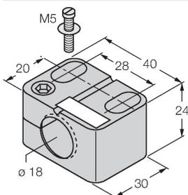
Befestigungsschelle für Gewinderohrsensoren, mit Festanschlag; Werkstoff: PA6
