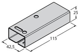
Schutzgehäuse für Neigungssensoren Q20L60 zum Schutz gegen mechanische Einwirkungen; Material: Edelstahl
