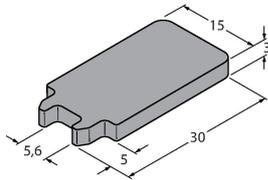
Lösewerkzeug der Montageelemente für Linearwegsensoren LI-Q17L
