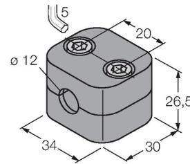
Befestigungsschelle für Glatt- und Gewinderohrsensoren; Werkstoff: Polypropylen
