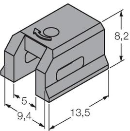
Klemmstück zur Montage von Magnetfeldsensoren auf Schwalbenschwanznutzylinder; Nutbreite: 9,4 mm; Werkstoff: PPS
