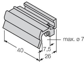
Zubehör zur Montage des Sensors BIM-INT und BIM-UNT auf Zugankerzylinder; Zylinderdurchmesser: 32... 40 mm; Werkstoff: Aluminium; weitere Zusatzhalterungen für unterschiedliche Zylinderdurchmesser auf Anfrage
