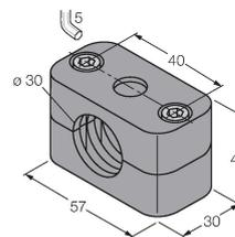
Befestigungsschelle für Glatt- und Gewinderohrsensoren; Werkstoff: Polypropylen
