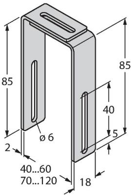
Montagewinkel für Linearwegensensoren Q25L, zur Montage auf Pneumatikzylindern (70...120 mm); Material: Edelstahl; 4 Stück pro Beutel
