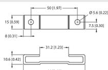
Montagefuß für Linearwegsensoren LI-Q25L; Material Aluminium; 2 Stück pro Beutel
