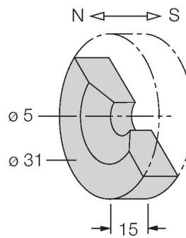
Betätigungsmagnet,  $\varnothing$  31 mm ( $\varnothing$  5 mm), h: 15 mm; erreichbarer Schaltabstand 90 mm auf Magnetfeldsensoren BIM-(E)M12 bzw. 78 mm auf BIM-EG08; bei Linearwegsensoren Q25L: empfohlene Entfernung zwischen Sensor und Magnet: 3...5 mm
