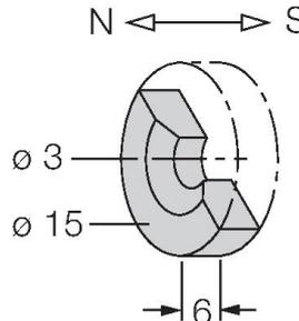
Betätigungsmagnet, Ø 15 mm (Ø 3 mm), h: 6 mm; erreichbarer Schaltabstand 36 mm auf Magnetfeldsensoren BIM-(E)M12 bzw. 32 mm auf BIM-EG08; bei Linearwegensensoren mit Q25L: empfohlene Entfernung zwischen Sensor und Magnet: 3...4 mm
