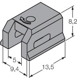
Klemmstück zur Montage von Magnetfeldsensoren auf  $\square$  Schwalbenschwanznutzylinder; Nutbreite: 9,4 mm; Werkstoff: PPS
