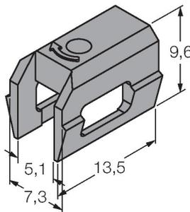
Klemmstück zur Montage von Magnetfeldsensoren auf  $\square$  Schwalbenschwanznutzylinder; Nutbreite: 7,35 mm; Werkstoff: PPS
