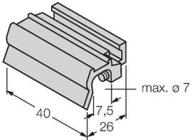
Zubehör zur Montage des Sensors BIM-INT und BIM-UNT auf  $\bigcirc$  Zugankerzylinder; Zylinderdurchmesser: 32... 40 mm; Werkstoff: Aluminium; weitere Zusatzhalterungen für unterschiedliche Zylinderdurchmesser auf Anfrage
