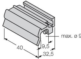
Zubehör zur Montage des Sensors BIM-INT und BIM-UNT auf  $\bigcirc$  Zugankerzylinder; Zylinderdurchmesser: 50... 63 mm; Werkstoff: Aluminium; weitere Zusatzhalterungen für unterschiedliche Zylinderdurchmesser auf Anfrage
