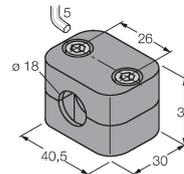
Befestigungsschelle für Glatt- und Gewinderohrsensoren; Werkstoff: Polypropylen
