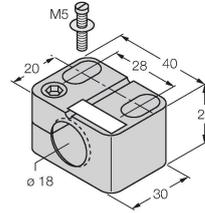
Befestigungsschelle für Gewinderohrsensoren, mit Festanschlag; Werkstoff: PA6
