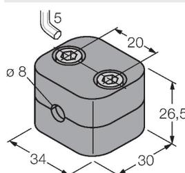
Befestigungsschelle für Glatt- und Gewinderohrsensoren; Werkstoff: Polypropylen
