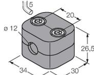
Befestigungsschelle für Glatt- und Gewinderohrsensoren; Werkstoff: Polypropylen
