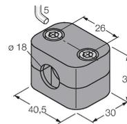
Befestigungsschelle für Glatt- und Gewinderohrsensoren; Werkstoff: Polypropylen
