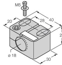
Befestigungsschelle für Gewinderohrsensoren, mit Festanschlag; Werkstoff: PA6
