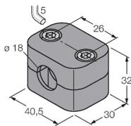
Befestigungsschelle für Glatt- und Gewinderohrsensoren; Werkstoff: Polypropylen
