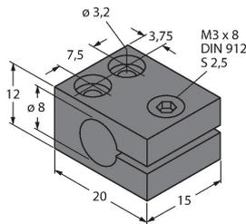
Befestigungsschelle für Gewinderohrsensoren; Werkstoff Montageblock: Aluminium, eloxiert
