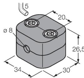
Befestigungsschelle für Glatt- und Gewinderohrsensoren; Werkstoff: Polypropylen
