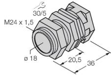
Schnellmontagehalterung mit Festanschlag; Werkstoff: Messing verchromt. Außengewinde M24 x 1,5. Hinweis: Der Schaltabstand der Näherungsschalter kann sich durch Verwendung von Schnellmontagehalterungen ändern.
