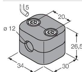
Befestigungsschelle für Glatt- und Gewinderohrsensoren; Werkstoff: Polypropylen
