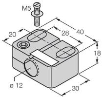
Befestigungsschelle für Gewinderohrsensoren, mit Festanschlag; Werkstoff: PA6
